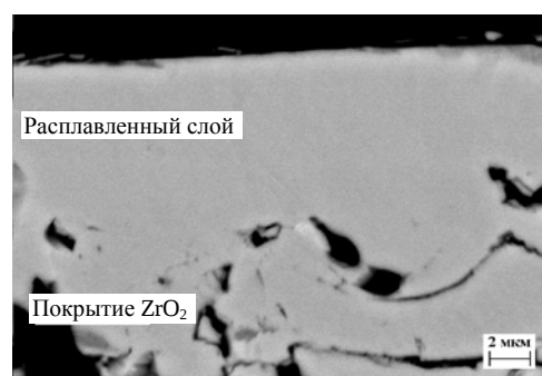
Рис. 11. Растровое электронно-микроскопическое изображение участка поперечного шлифа приповерхностного слоя покрытия, расплавленного после воздействия компрессионными плазменными потоками
