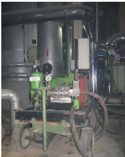
Рис. 5. Очистная установка высокого давления «КАМАТ K451A-E45B» (ФРГ), обеспечивающая реверсивно-струйную очистку со скоростью струи v_{стр} = 350\text{--}550 м/с
