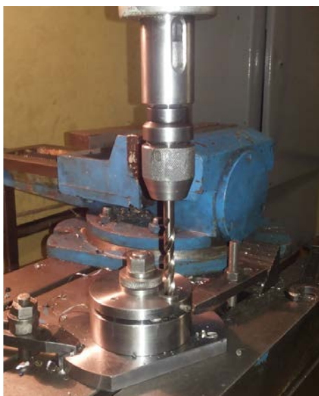
Рис. 2. Кондуктор для исследования процесса сверления отверстия диаметром 10 мм
