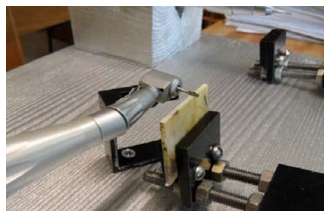
Рис. 3. Принципиальная схема устройства для определения режущей способности бора (а) и фотография его рабочей зоны (б)
