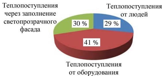
Рис. 1. Структура теплоступлений в помещение
