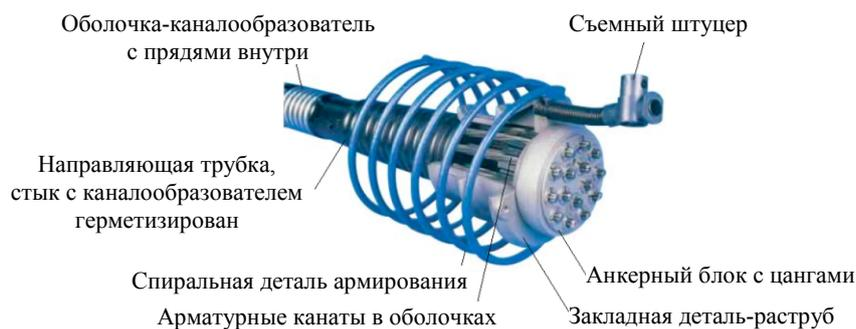
Рис. 3. Принципиальная схема анкерного узла системы multistrand
