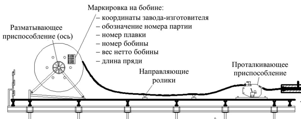
Рис. 4. Размещение оборудования при протягивании прядей
