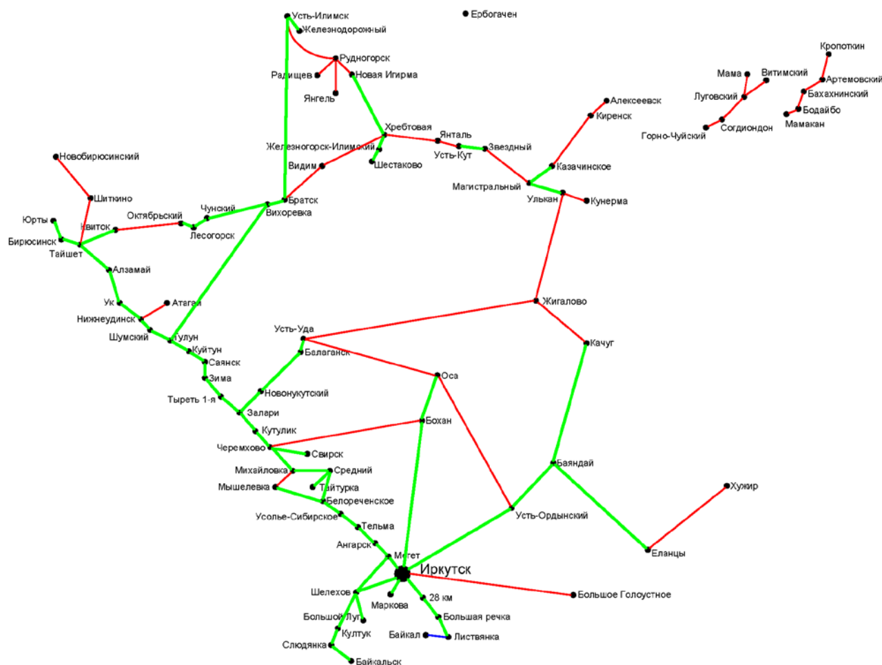
Рис. 1. Графовая модель автодорожной сети Иркутской области. Различные типы линий соответствуют разным типам дорог, для которых установлены соответствующие лимиты допустимых скоростей передвижения
