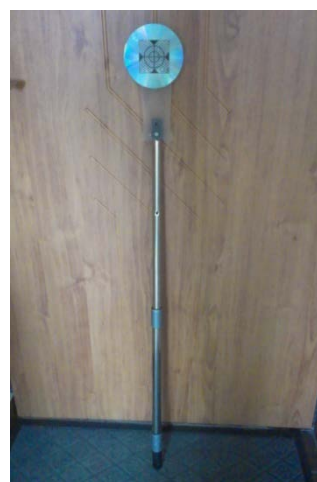
Рис. 2. Переносная светоотражательная диск-марка
