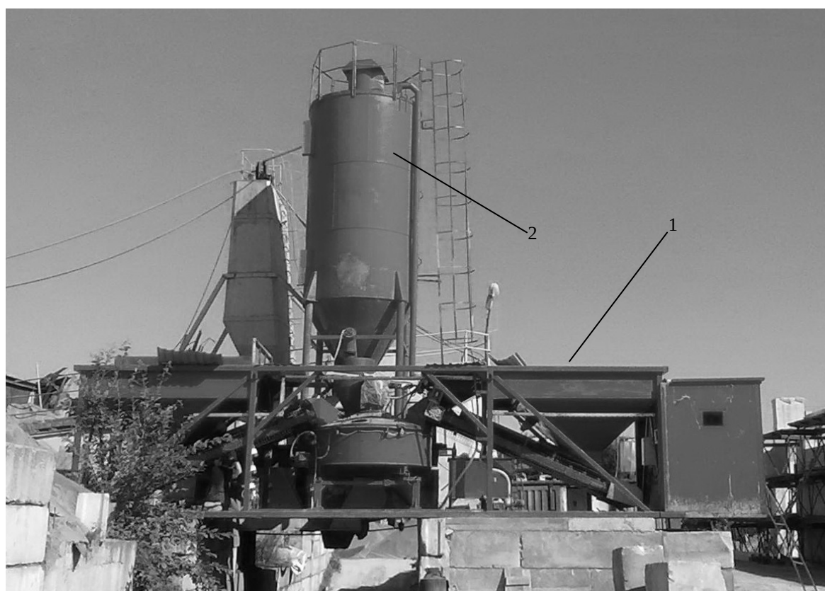
Рис. 2. Общий вид опытного образца МРБК: 1 – бетономесительный модуль; 2 – модуль хранения цемента
