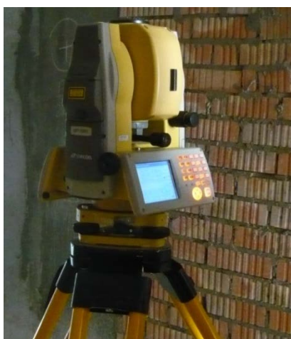
Рис. 1. Электронный тахеометр в положении измерения зенитных углов
