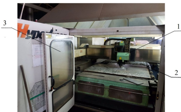
Рис. 1. Внешний вид комплекса лазерной резки HYPER GEAR 510: 1 – дверь закрытия рабочей зоны; 2 – паллета; 3 – модуль лазерного станка
