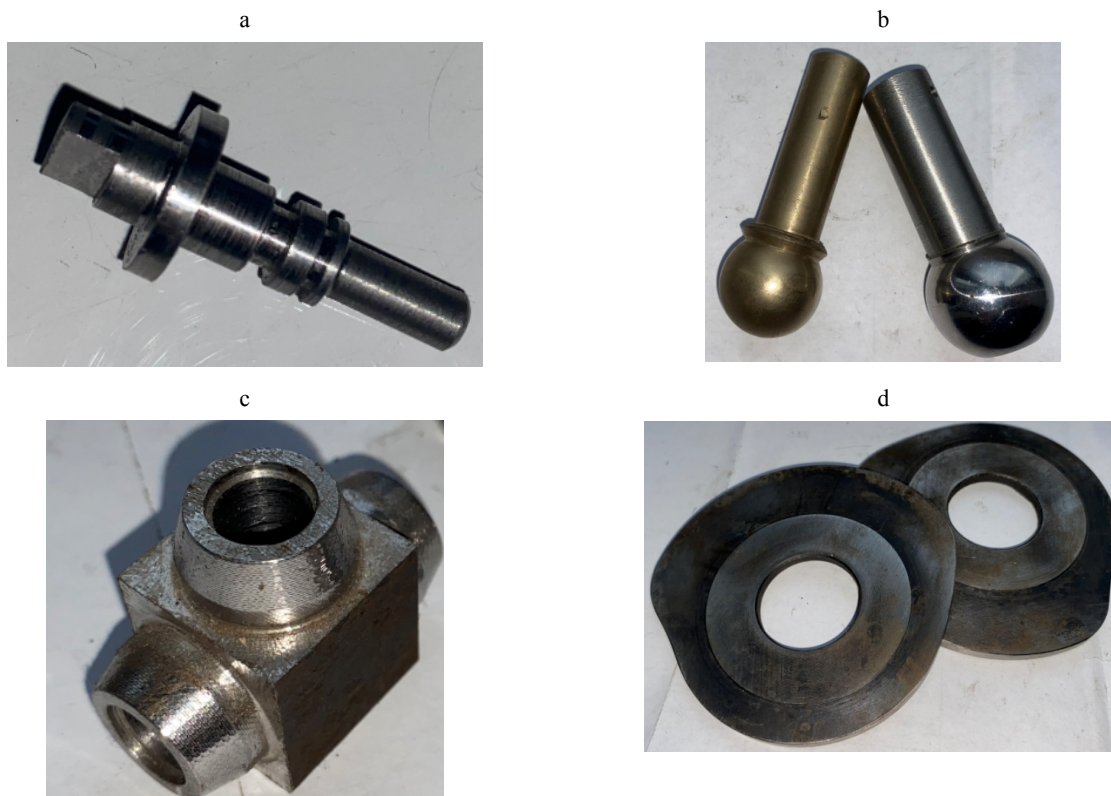
Рис. 10. Образцы изготовленных деталей с цилиндрическими и плоскими (а), сферическими (б), коническими (с) и криволинейными (d) поверхностями
