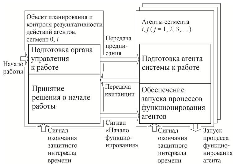
Рис. 2. Схема начальной инсталляции и запуска процессов штатного функционирования одного сегмента топологии мультиагентной системы
