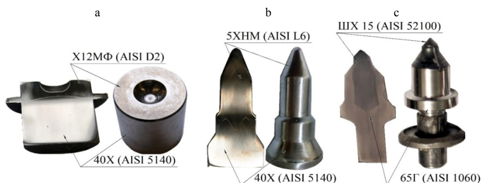
Рис. 7. Детали-представители и их шлифы: а – вставка пуансона; б – прошивной пуансон; с – тангенциальный резец
