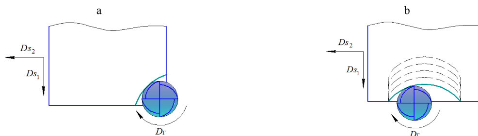
Рис. 2. Схемы обработки с врезанием фрезы по дуге: а – уступа; б – полузакрытой полости
