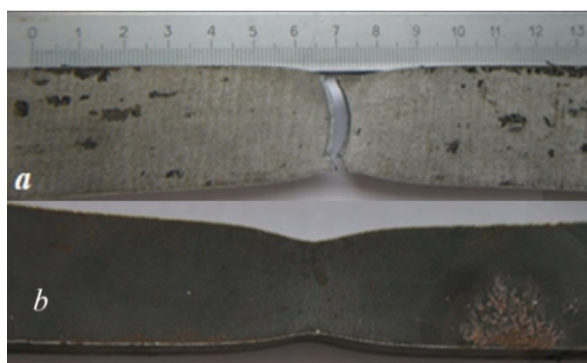
Рис. 4. Общий вид образцов 1 и 2 после испытания: а – излом образца 1; б – шейка в образце 2
