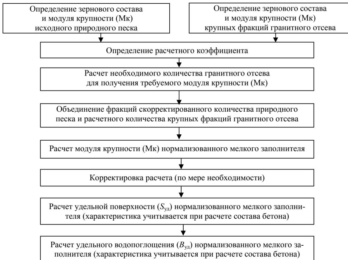
Рис. 1. Структурная схема алгоритма программы Normalization
