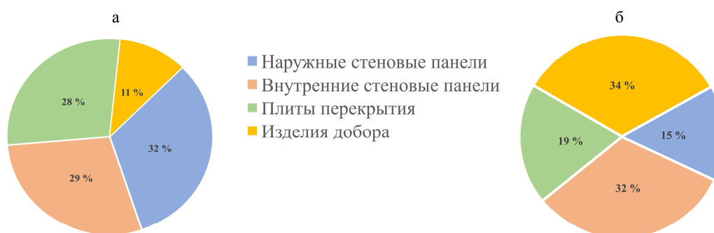
Рис. 1. Доля изделий в номенклатуре типовых серий: а – по бетоноемкости изделий, м 3 ; б – по количеству изделий, шт.
