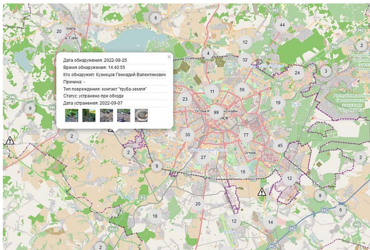
Рис. 3. Электронная карта с группировкой выявленных дефектов изоляции в МПК «Вершина»
