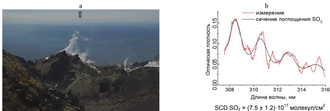
Рис. 7. Вулканический шлейф выброса на о. Чиринкотан за два дня до извержения (а) и пример восстановления наклонных содержаний \text{SO}_2 (б)
