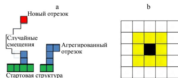
Рис. 1. Алгоритм построения модели центральной трещины с новыми отрезками в DLA-приближении:
