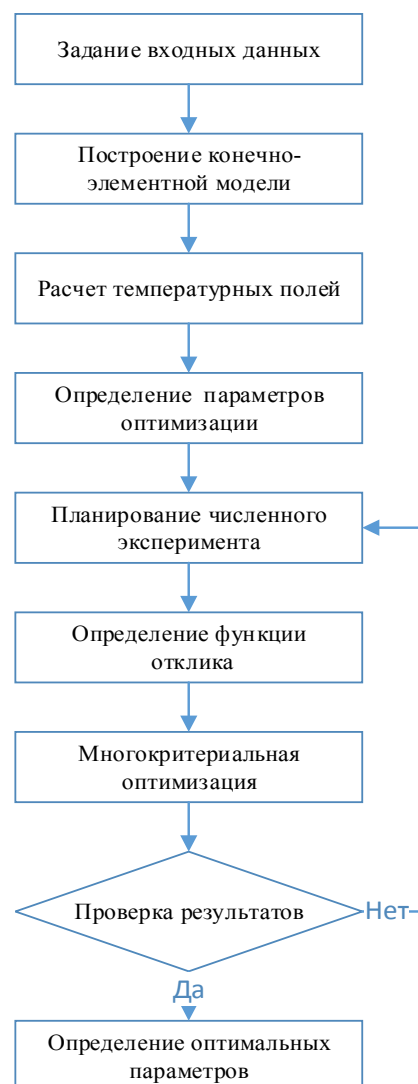
Рис. 4. Алгоритм оптимизации лазерной обработки стали кольцевыми пучками
