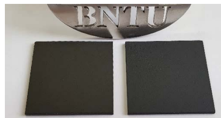
Рис. 2. Внешний вид образцов с полученными черными керамическими покрытиями в электролитах: слева – SAT; справа – SPF
