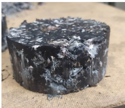
Рис. 2. Образец формования щебня, укрепленный асфальтогранулятом
