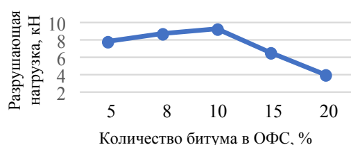
Рис. 8. Зависимость разрушающей нагрузки от количества битума в отработанной формовочной смеси
