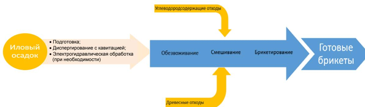
Рис. 4. Последовательность операций получения брикетированного MSF-топлива
