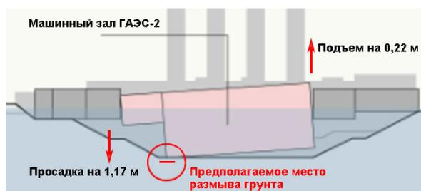
Рис. 5. Схема аварии на Загорской ГАЭС-2 [17]
