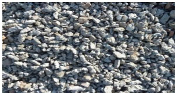
Рис. 1. Цементогранулят, используемый при испытаниях
