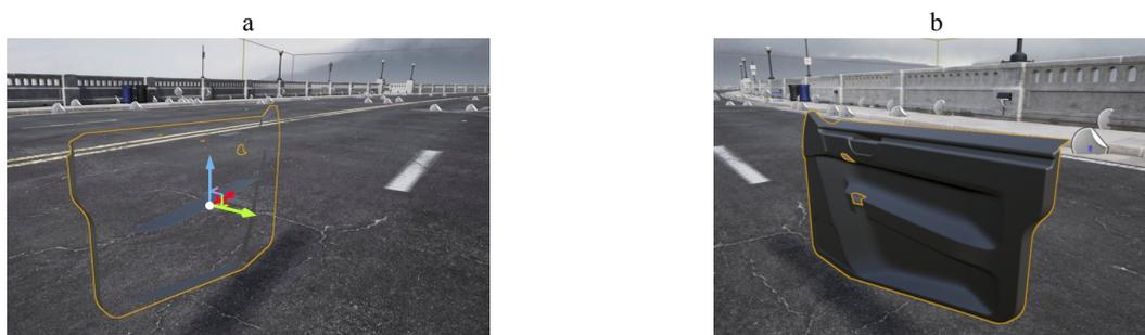
Рис. 3. Корректировка нормалей, обращенных от пользователя (а) и на пользователя (б), в трехмерной модели обшивки двери электромобиля
