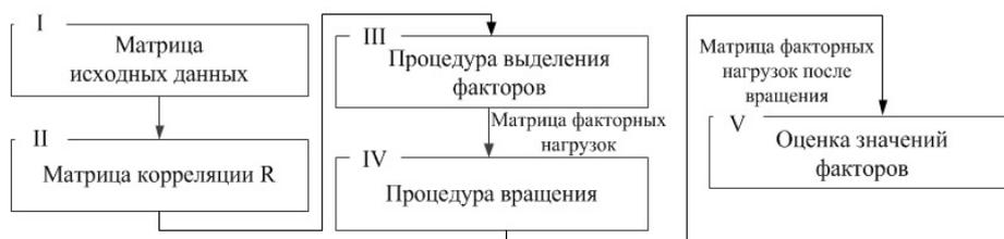
Рис. 1. Этапы проведения редукции коэффициентов аварийности
