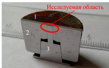
Рис. 2. Поперечное сечение штифтового образца: 1 – покрытие; 2 – шайба (основа); 3 – штифт
