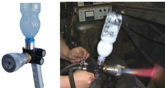
Рис. 1. Внешний вид термораспылителя установки ОИМ 050 и процесс нанесения покрытия
