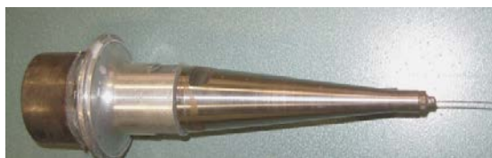
Рис. 1. Акустическая система для ультразвуковой обработки отверстий
