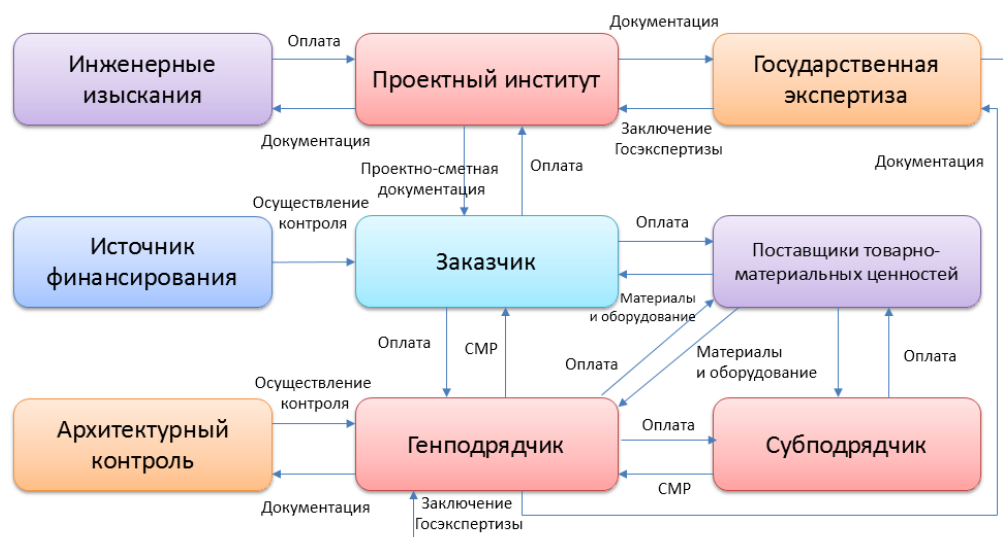
Рис. 2. Модель управления строительством многоквартирного жилого дома
