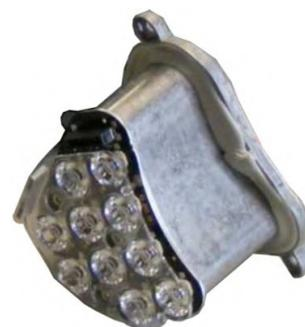
Рис. 1. Светодиодный модуль указателя поворота в фаре автомобиля BMW F10/F11 производства фирмы HELLA
