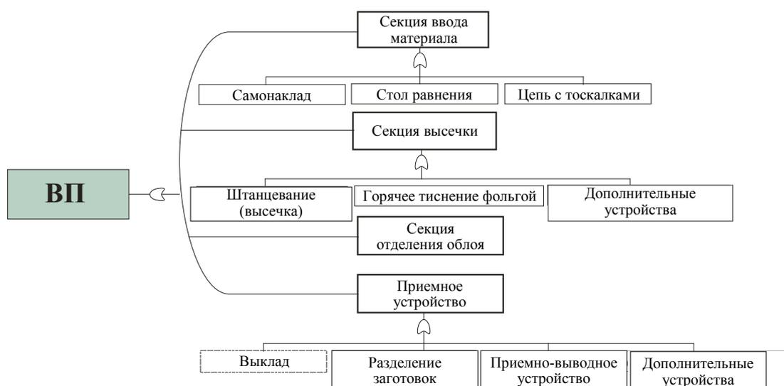
Рис. 2. Схема высекального пресса
