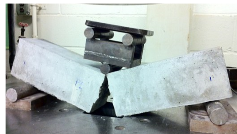
Рис. 7. Испытание бетонных призм размерами 15×15×60 см
