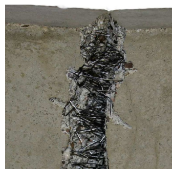
Рис. 5. Образец бетона, армированного полипропиленовой фиброй длиной 12 мм, после испытания на сжатие
