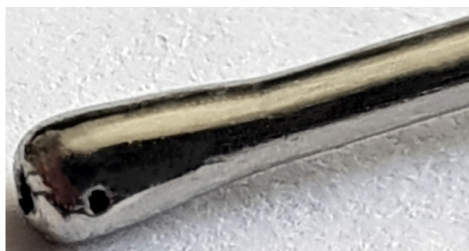
Рис. 8. Фотография наконечника с прошитыми микроотверстиями
