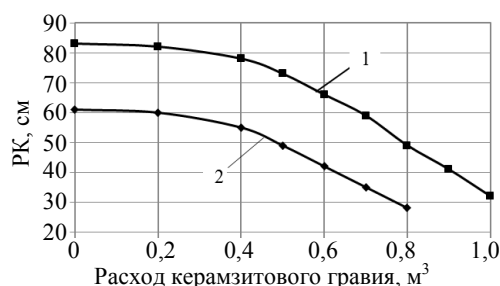
Рис. 5. Зависимость формуемости (пластичности) керамзитопенобетонной смеси от расхода керамзитового гравия и вида примененной добавки:
