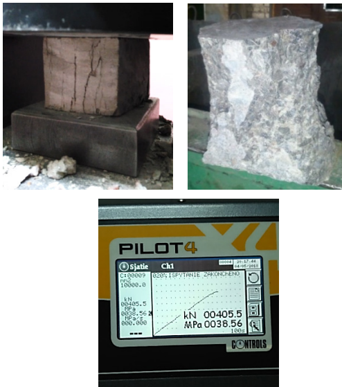
Рис. 3. Испытание образцов на прочность
