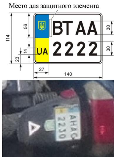
Рис. 4. Размеры номерного знака согласно ДСТУ 3650:2004
