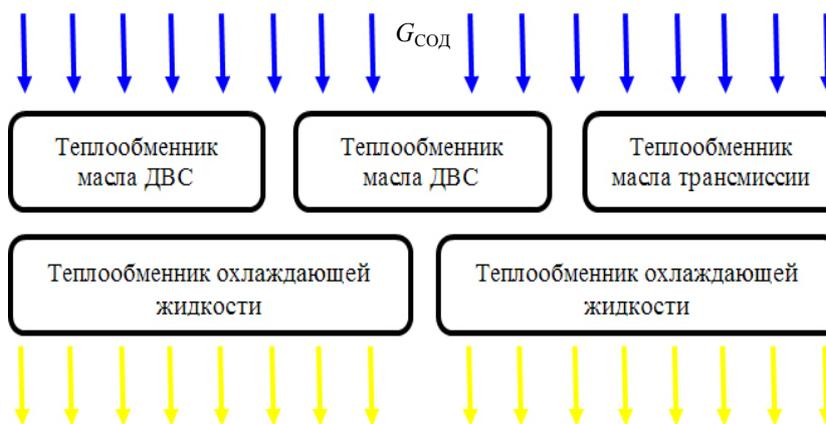
Рис. 4. Схема расположения теплообменников системы охлаждения дизеля
