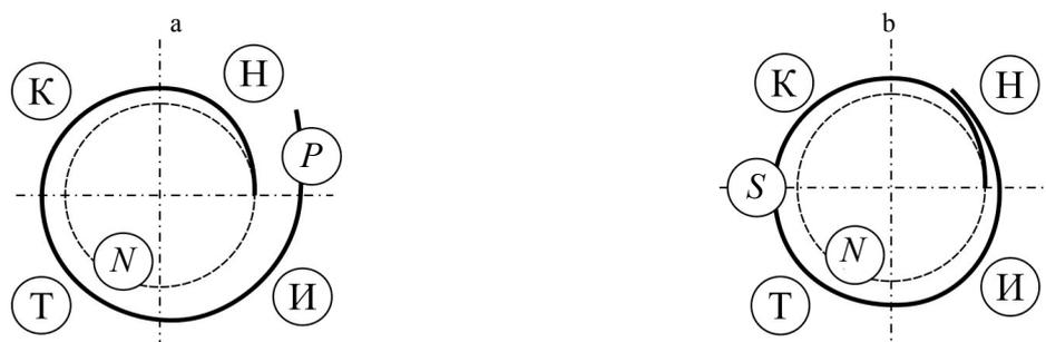
Рис. 1. Реализация связи а – в системе «нагрузка – контактное давление – трение – износ» (НКТИ) при традиционных видах упрочняющей обработки деталей; б – в системе НКТИ при дискретно-континуальном упрочнении: *N* – номинальный цикл процесса; *P* – прогрессирующее самоускоряющееся развитие исследуемых процессов и состояний; *S* – стабилизирующееся самозамедляющееся развитие исследуемых процессов и состояний
