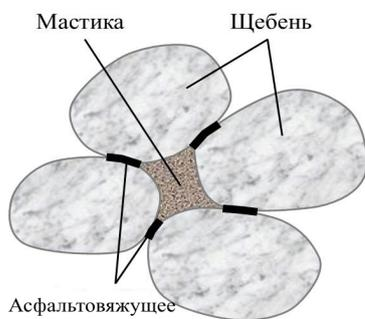
Рис. 2. Структура реального асфальтобетона
