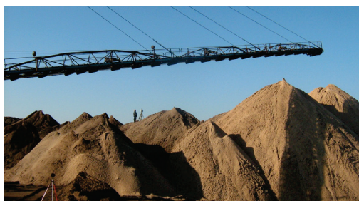
Рис. 1. Солеотвалы. Использование лазерного сканера Leica ScanStation C10 для создания цифровой модели рельефа
