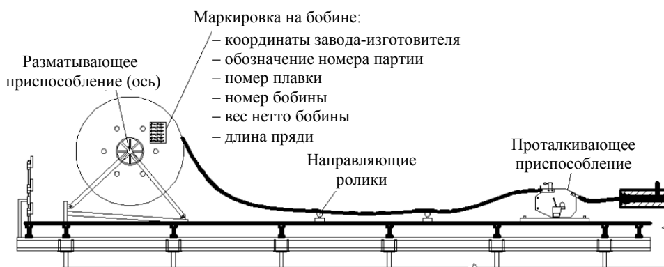
Рис. 4. Размещение оборудования при протягивании прядей
