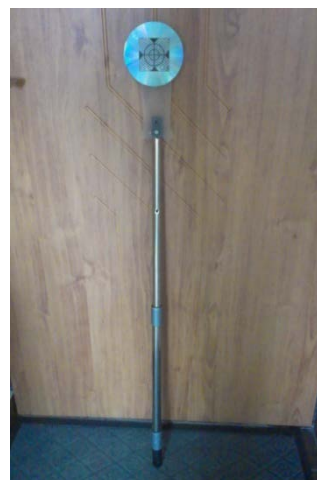
Рис. 2. Переносная светоотражательная диск-марка
