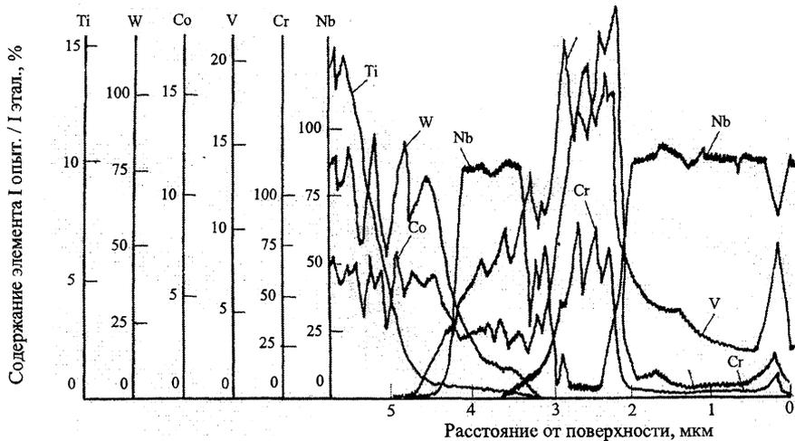
Рис. 5. Распределение элементов в диффузионном слое на твердом сплаве Т15К6, полученном при  $T = 1100\text{ }^{\circ}\text{C}$  и  $\tau = 6\text{ ч}$  ( $\times 240$ ). Состав насыщающей смеси по основным компонентам 50 %  $\text{V}_2\text{O}_5 + 25\% \text{Nb}_2\text{O}_5 + 25\% \text{Cr}_2\text{O}_3$
