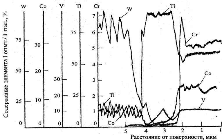
Рис. 6. Распределение элементов в диффузионном слое на твердом сплаве Т15К6, полученном при  $T = 1100\text{ }^{\circ}\text{C}$  и  $\tau = 6\text{ ч}$  ( $\times 240$ ). Состав насыщающей смеси по основным компонентам 50 %  $\text{TiO}_2 + 25\% \text{V}_2\text{O}_5 + 25\% \text{Cr}_2\text{O}_3$
