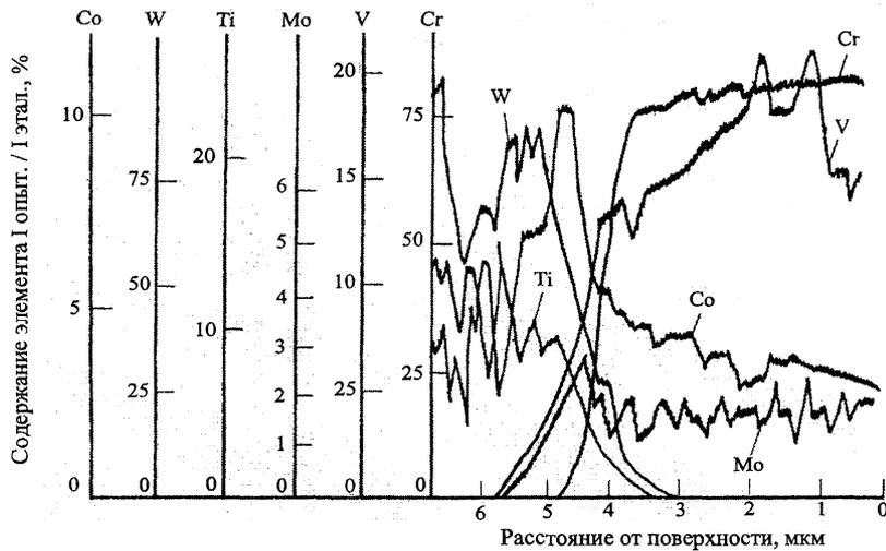
Рис. 4. Распределение элементов в диффузионном слое на твердом сплаве Т15К6, полученном при  $T = 1100\text{ }^{\circ}\text{C}$  и  $\tau = 6\text{ ч}$  ( $\times 240$ ). Состав насыщающей смеси по основным компонентам 50 %  $\text{V}_2\text{O}_5 + 25\% \text{MoO}_3 + 25\% \text{Cr}_2\text{O}_3$
