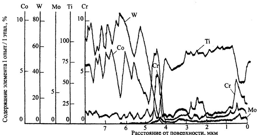
Рис. 7. Распределение элементов в диффузионном слое на твердом сплаве T15K6, полученном при  $T = 1100\text{ }^\circ\text{C}$  и  $\tau = 6\text{ ч}$  ( $\times 240$ ). Состав насыщающей смеси по основным компонентам 50 %  $TiO_2 + 25\text{ \% } MoO_3 + 25\text{ \% } Cr_2O_3$
