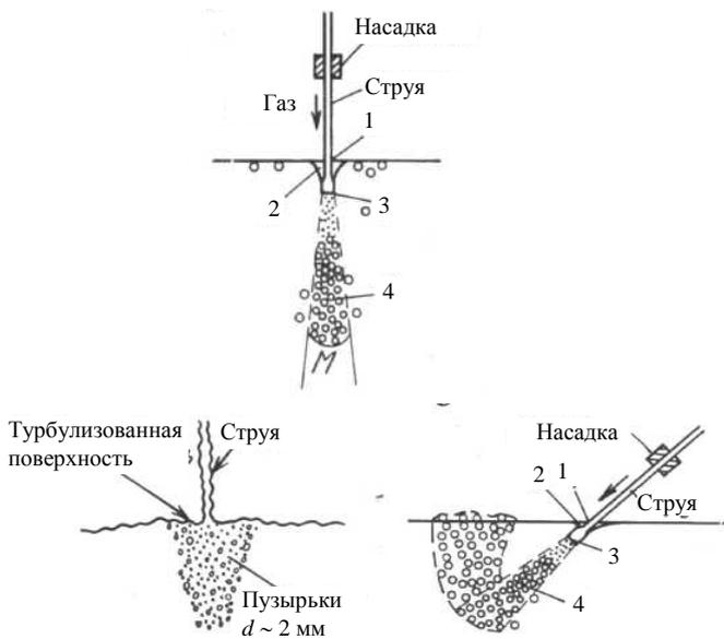
Рис. 1. Схемы падения вертикальной и наклонной струй на поверхность жидкости: 1 – точка входа струи; 2 – кратер; 3 – цилиндрический разрыв; 4 – ядро «факела»
