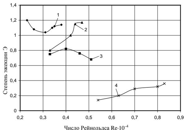
Рис. 6. Влияние числа Рейнольдса и диаметра на степень эжекции для водяных струй круглого и кольцевого сечений с наружным диаметром  $D = 8$  мм: 1 –  $d = 7$  мм; 2 – 6; 3 – 4; 4 – круглое сечение  $D = 8$  мм
