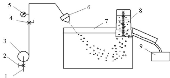
Рис. 4. Схема измерения объема аэрированной струей воздуха: 1 – всасывающий трубопровод насоса; 2 – вентиль для регулировки расхода; 3 – центробежный насос; 4 – шаровой кран; 5 – манометр; 6 – форсунка; 7 – модель флотокамеры; 8 – мерная емкость для определения расхода воздуха; 9 – то же расхода воды
