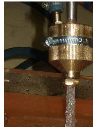
Рис. 3. Форсунка для струйной аэрации
