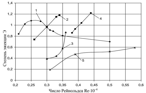
Рис. 7. Влияние числа Рейнольдса и диаметра на степень эжекции для водяных струй круглого и кольцевого сечений с наружным диаметром  $D = 9$  мм: 1 –  $d = 8$  мм; 2 – 7; 3 – 6; 4 – 4; 5 – круглое сечение  $D = 9$  мм
