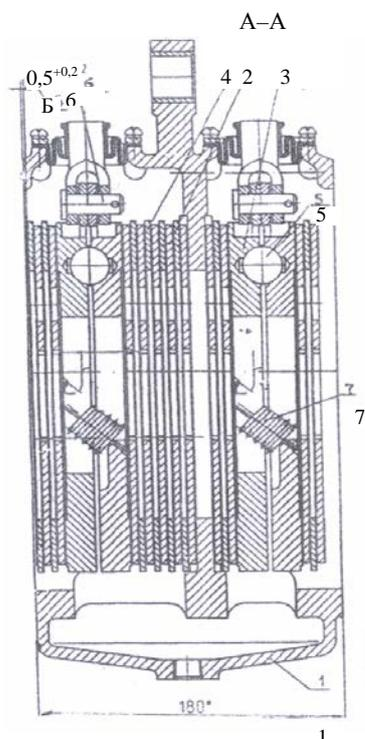
Рис. 3. Сборочный чертеж  $180^\circ$ озных механизмов модели 1221М трактора «Беларус». Проекция А-А: 1 – корпус тормозных механизмов; 2 – нажимные диски; 3 – то же разжимные; 4 – то же промежуточные; 5 – шаровые опоры разжимных дисков; 6 – шарнирный механизм; 7 – возвратные пружины
