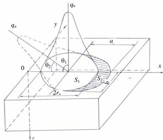
Рис. 2. Теплофизическая модель формирования пятна нагрева на поверхности металла в случае нормального и полого падающего лазерных лучей в зону обработки
