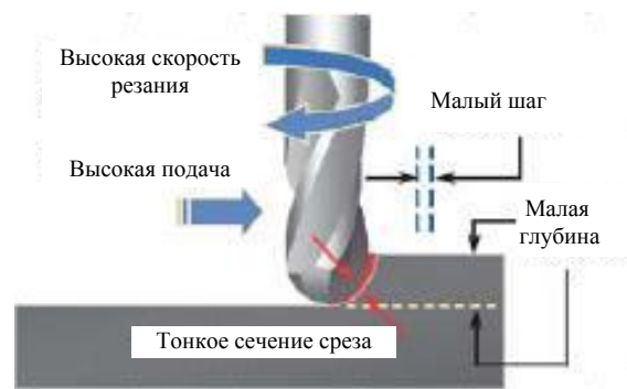
Рис. 2. Параметры резания для высокоскоростной обработки
