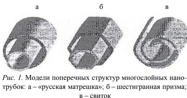
Рис. 1. Модели поперечных структур многослойных нанотрубок: а – «русская матрешка»; б – шестигранная призма; в – свиток
