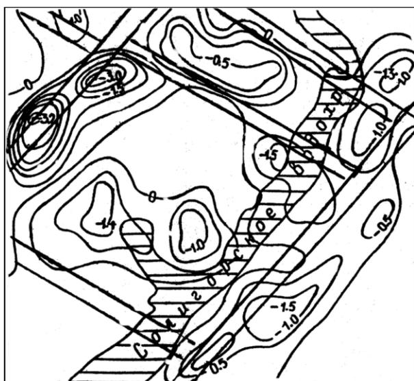
Рис. 4. Фрагмент карты явного остаточного рельефа: 1 – явный остаточный рельеф; 2 – западины; 3 – предполагаемые линии разрывных нарушений
