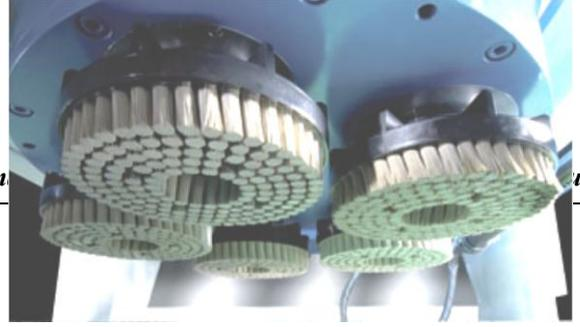
Рис. 1. Инструмент для финишной обработки Wurt-Ex
