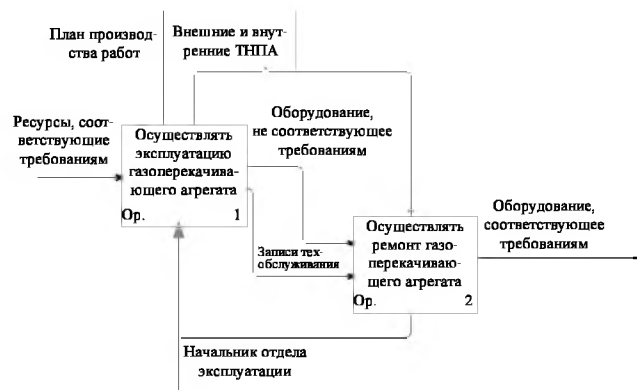
Рис. 1. Процессы, связанные с функционированием ГПА и записанные при помощи языка функционального моделирования по методологии IDEF0
