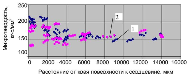
Рис. 5. Распределение микротвердости по сечению арматурных стержней Ø 25 мм: 1 – поперечное сечение; 2 – продольное
