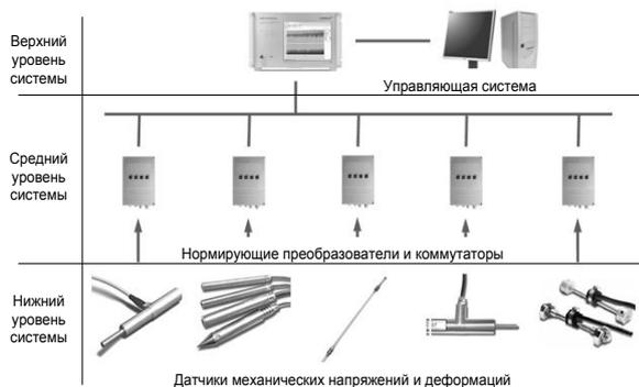
Рис. 2. Типовая структура системы строительного мониторинга
