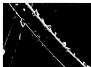
Фото 6. Осаждение частиц кварца на волокнах при различных числах Рейнольдса. Поток движется сверху вниз. Размер волокон полиэстера d_f = 17,4 \text{ мкм}
