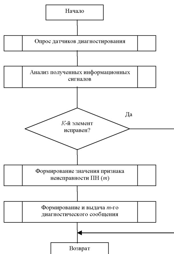
Рис. 3. Укрупненная блок-схема алгоритма бортового диагностирования технических средств и объекта диагностирования
