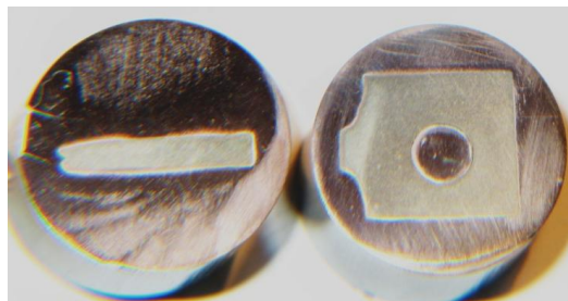
Рис. 1. Вид шлифов из образца после испытания на растяжение
