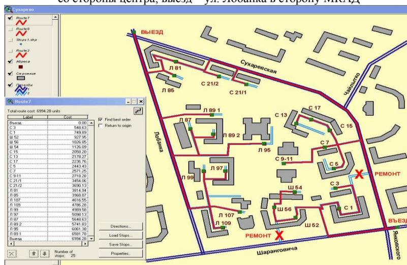
Рис. 3. Результат моделирования оптимального маршрута при сборе ТБО (некоторые внутренние проезды закрыты для движения автотранспорта)
