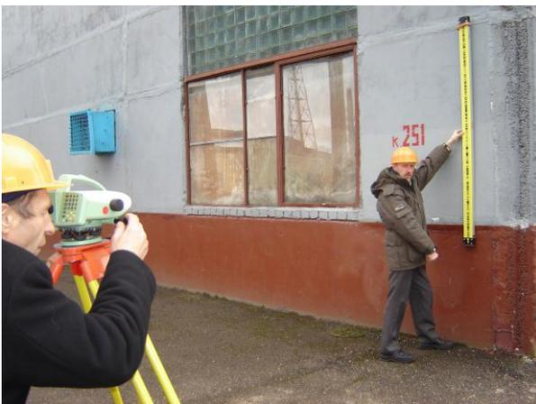
Рис. 1. Наведение зрительной трубы нивелира на кодовую рейку
