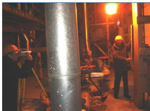
Рис. 2. Работа с цифровым нивелиром в цехе «Аммиак»
