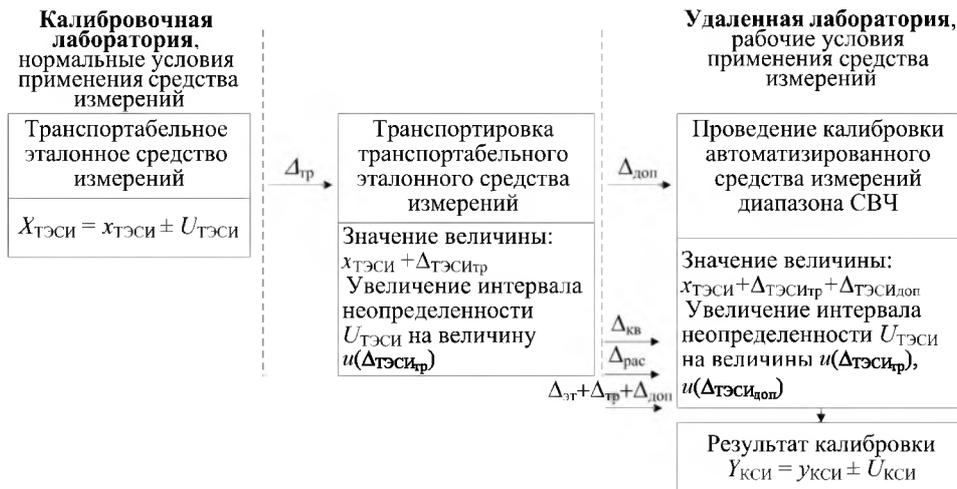
Рис. 2. Величины, влияющие на калибровочную характеристику ТЭСИ на каждом этапе их применения
