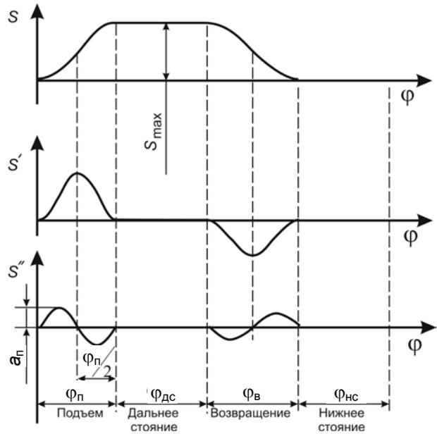
Рис. 2. Закон движения выходного звена кулачкового механизма
